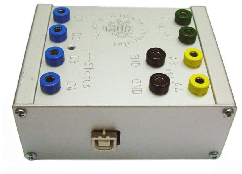
Abbildung 2: Gehäuse mit USB-Anschluss
