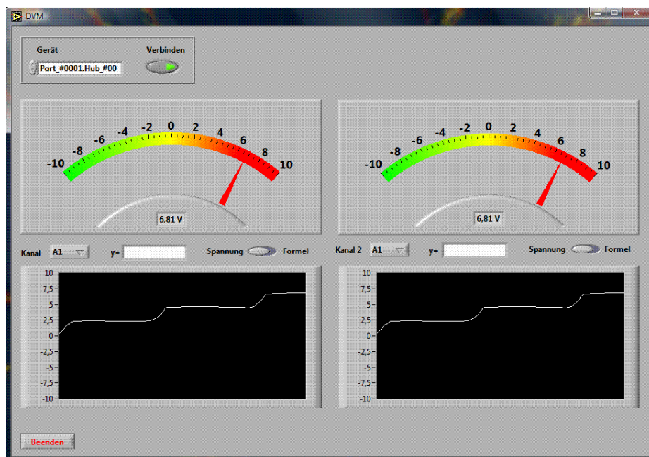
Abbildung 48: Schrittweises Aufladen des FARADAY-Behlers unter Verwendung des Metallkugelstabes und einer 1\text{ nF} -Kapazität bei 2\text{ kV}
