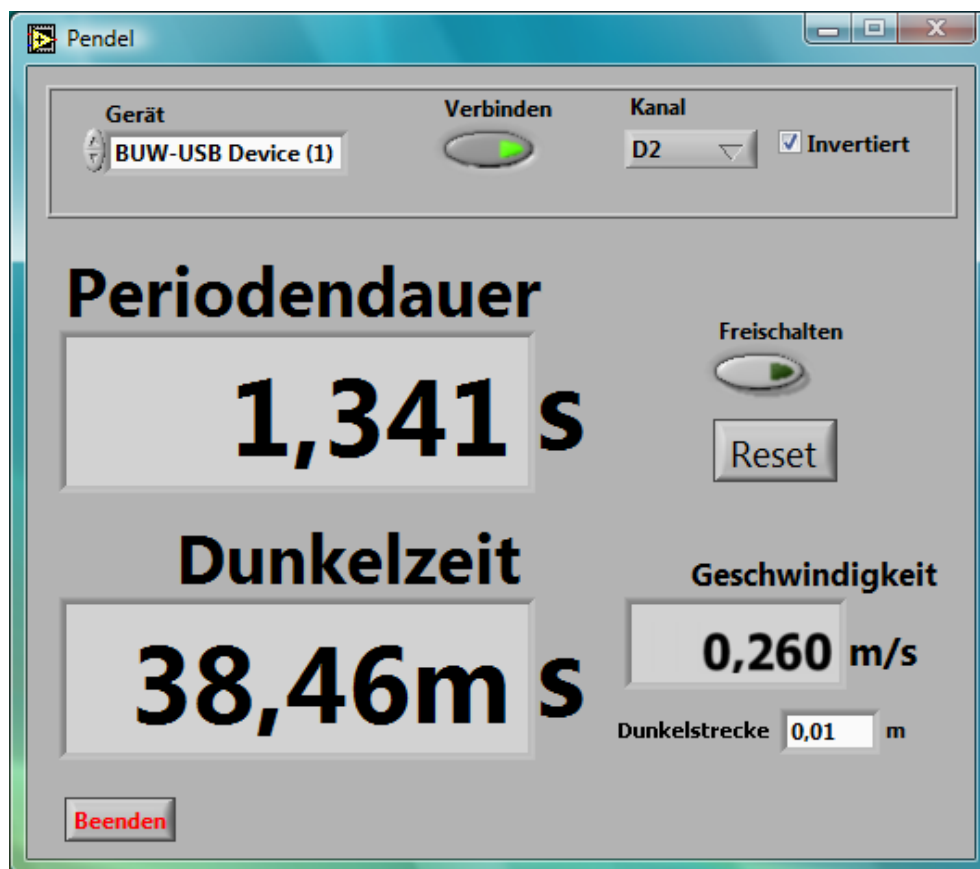
Abbildung 34: Messung einer Schwingungsperiode T : Der Messkanal (hier D2) muss auf \checkmark Invertiert geschaltet sein, um Dunkelzeiten zu messen. Bei einer angenommenen Pendelstangendicke von d = 1\text{ cm} erhält man im Bsp. eine Durchlaufgeschwindigkeit an der Lichtschranke von c = 26\frac{\text{cm}}{\text{s}} .
